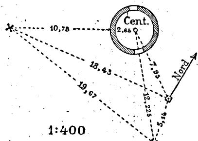
ein von ihm erstellter Beobachtungspfeiler, dessen Centrum genau mit dem des alten excentrischen Beobachtungspfeilers  $\alpha$  übereinstimmend gemacht wurde. Der Pfeiler, in Bruchsteinmauerwerk mit Cementmörtel ausgeführt, trägt in seiner Mittelachse eine Eisenröhre, unter welcher centrisch eine ca. 6 cm lange Schraube eincementiert ist.
