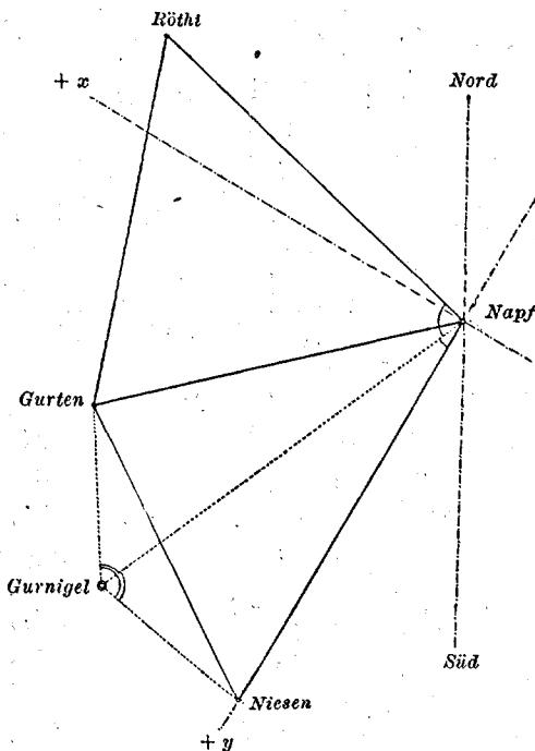
Für den geodätischen Anschluss wurde gelegentlich der astronomischen Beobachtungen auf Gurnigel und Napf mit dem Repsoldschen Universalinstrumente die folgenden Winkel gemessen :
