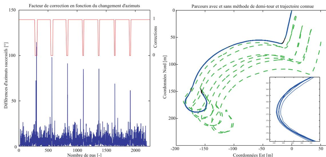
FIG. 4.17 – Lors d'une marche normale, l'oscillation de l'azimut causée par la marche elle-même avant filtrage est importante. Néanmoins, la détection de virages brusque est facilement réalisable. L'application de procédures particulières permet d'améliorer le calcul de la trajectoire. Avec une méthode appropriée, un écart de fermeture de 60m sur une distance de 2'430m c.à d. 2.5 % peut être réduit à 2.8 m soit 0.1% de la distance parcourue.
