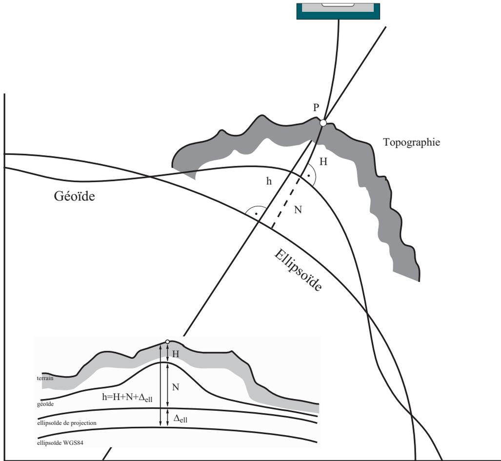
FIG. 3.10 – Relation entre les altitudes orthométrique, ellipsoïdique et la cote du géοide. Si la cote du géοide est fournie par rapport à un autre ellipsoïde que WGS84, la différence entre ceux-ci doit être prise en compte lors du calcul de la hauteur mesurée par GPS.
