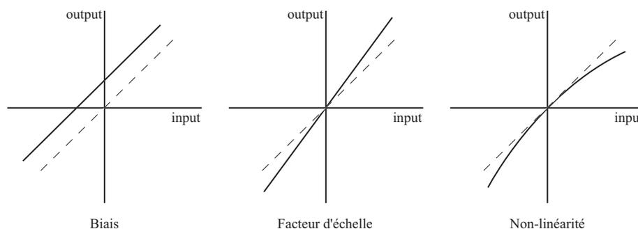
FIG. 3.7 – Principales erreurs input/output d'un gyroscope.
