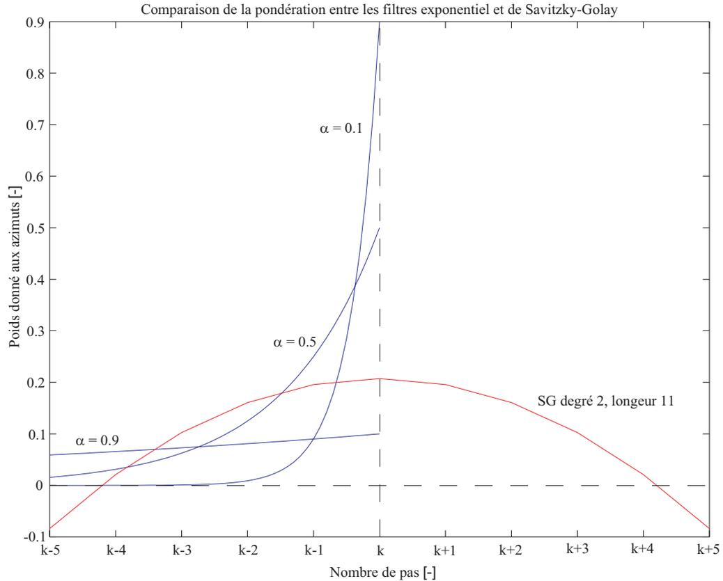
FIG. 4.10 – Représentation des différents coefficients de pondération en fonction du type de filtre et de paramètre utilisés. Pour des grandes valeurs de  $\alpha$  le filtre exponentiel s’approche d’un filtre à réponse impulsionnelle finie. En phase stable, le filtre de Savitzky-Golay est lui symétrique par rapport à l’époque considérée, donnant dans le cas présent autant de poids aux valeurs précédant que suivant l’azimut calculé.
