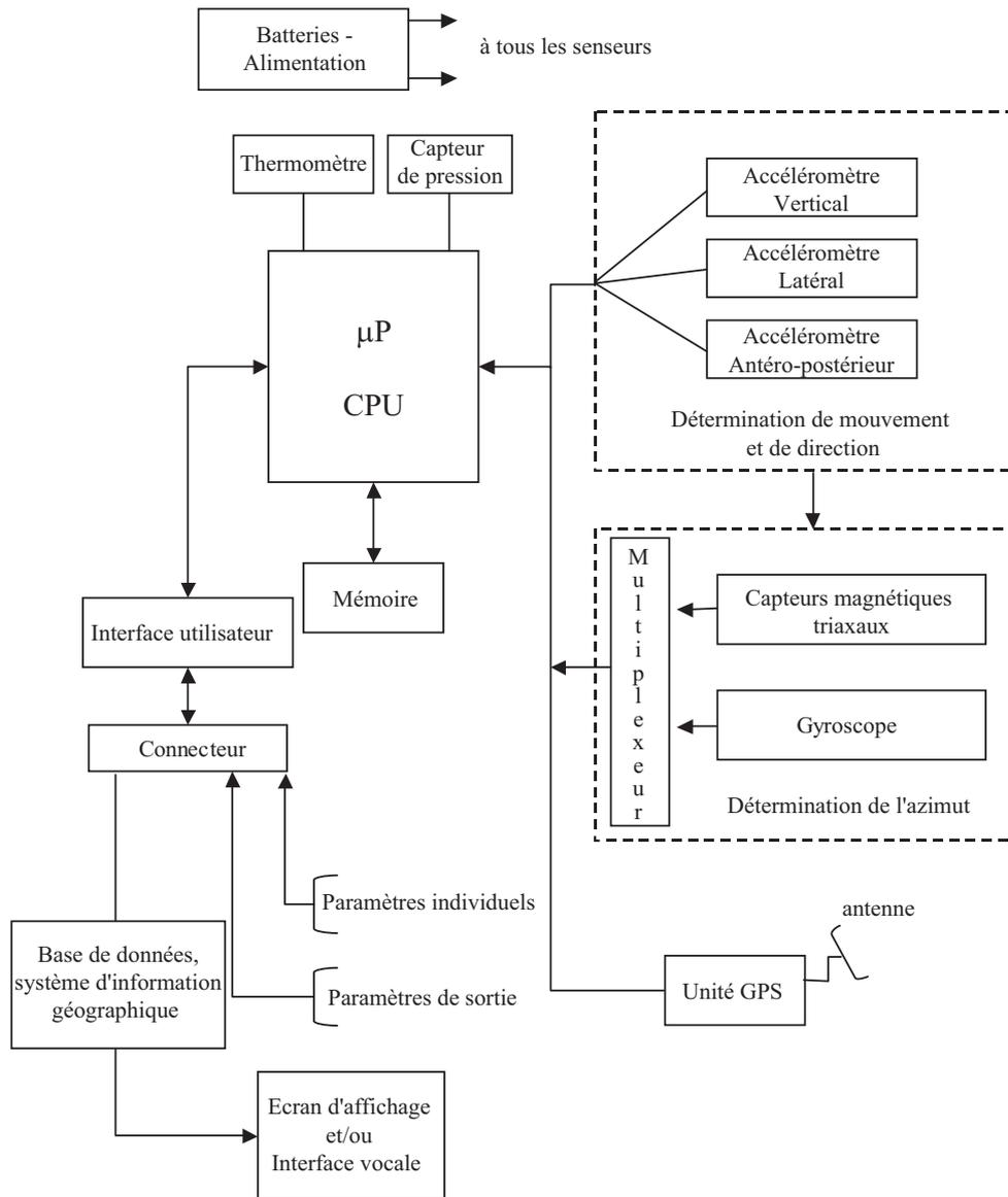
FIG. 4.1 – Représentation schématique du système de navigation pédestre. Les différents capteurs fonctionnent en parallèle à des fréquences pouvant être choisies par l'utilisateur selon le type d'application désiré. Une interface graphique ou vocale liée à une base de données permet une navigation interactive également pour les personnes aveugles.
