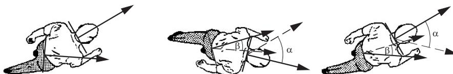
FIG. 2.4 – Rotations inverses de la taille ( $\beta$ ) et des épaules ( $\alpha$ ) durant la marche. Ces mouvements, pouvant être supérieurs à  $10^\circ$ , devront être filtrés afin de permettre une détermination optimale de l'azimut de déplacement, inspiré de Murray (1967).
