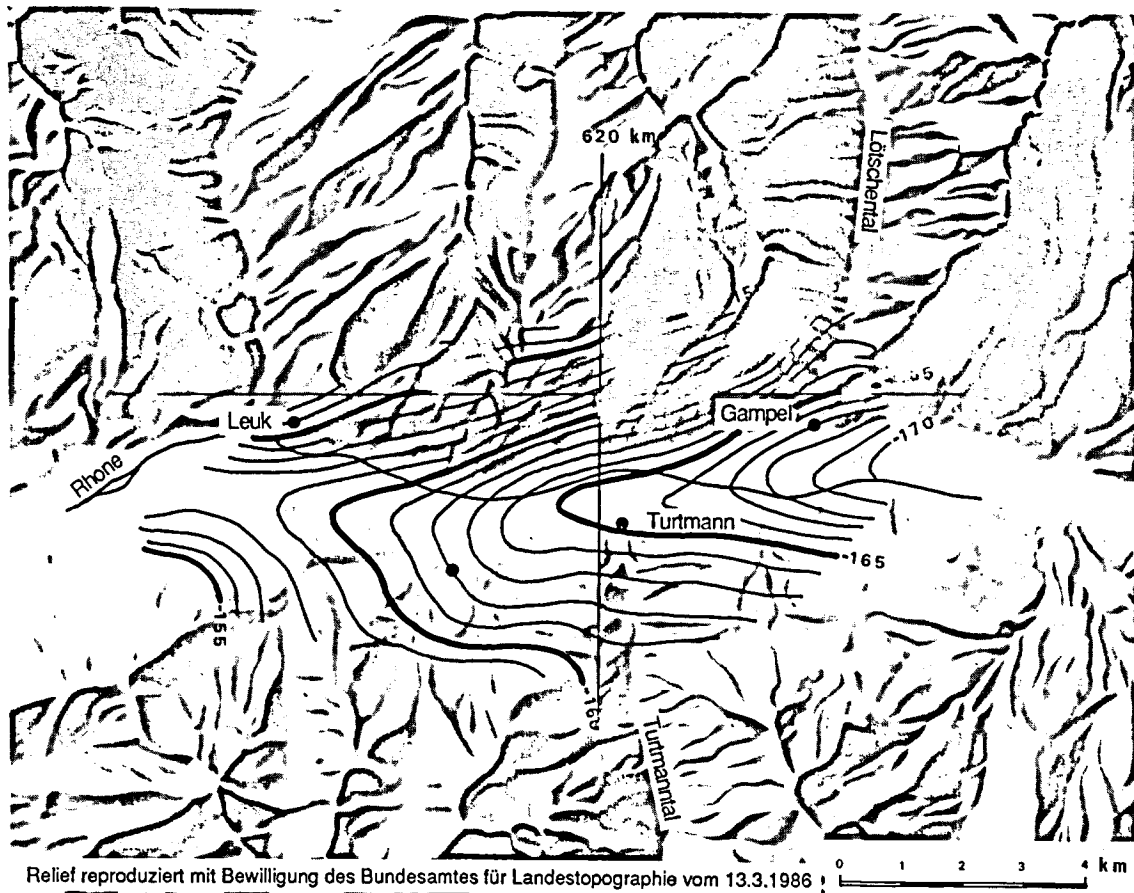
Abbildung 4.2-2: Isolinienkarte der Bouguer - Anomalien [Einheit : \text{mgal} = 10^5 \text{ms}^{-2} ] für \rho_{\text{ref}} = 2.67 \text{g/cm}^3 . Isolinien - Abstand : 1 mgal
