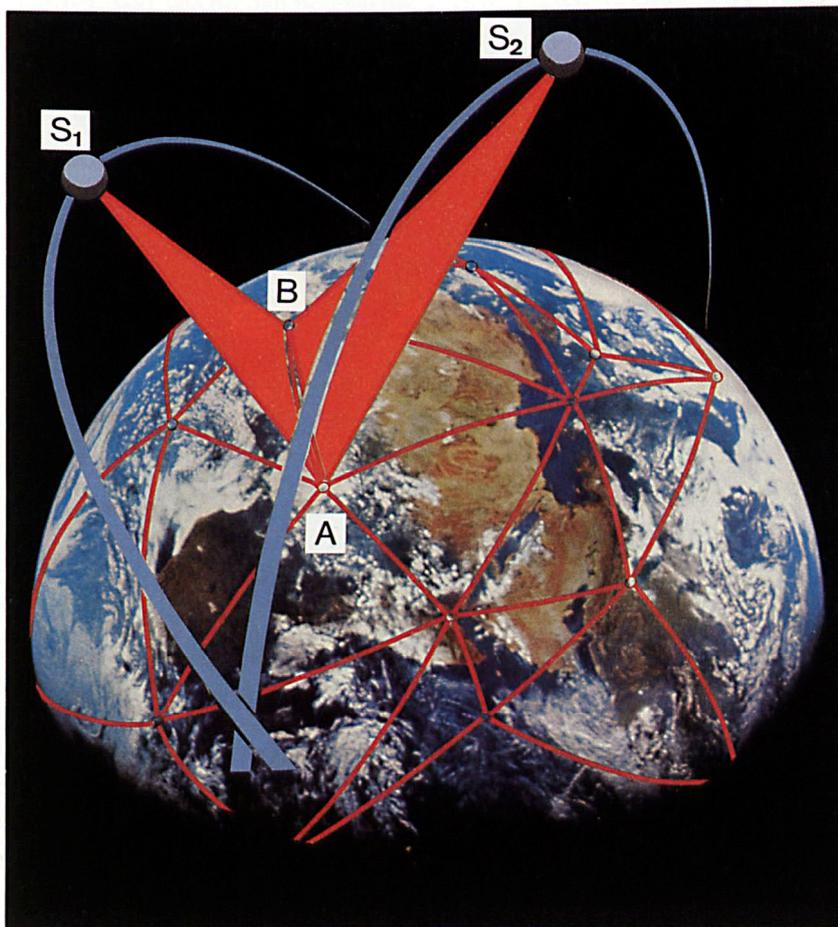
Abb. 2: Aufbau räumlicher Netze mit Hilfe der Satellittriangulation.
