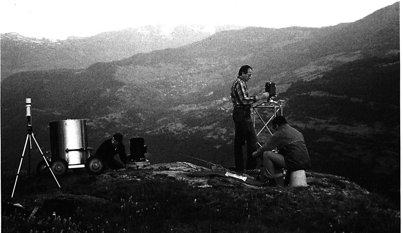
Abb. 5: Einsatz der TZK 3 im GPS-Testnetz Turtmann.
