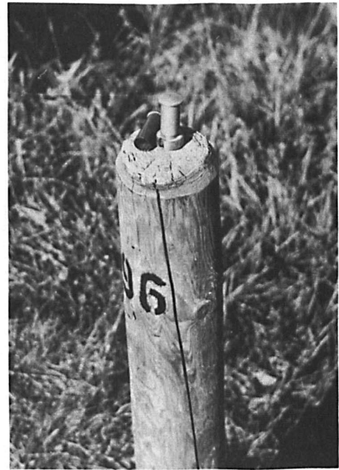
Bild 20: Jäderinzapfen 96 mit aufgesetztem Nivellierhütchen
