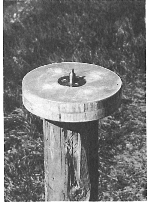
Bild 10: Als Instrumentenstandpunkt ausgebildeter Holzpfahl mit Jäderinzapfen
