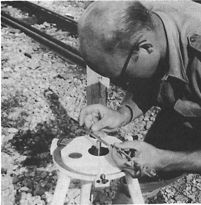
Bild 17: Eisenrohrstativ mit verschiebbarem Teller und drei Stell-schrauben
