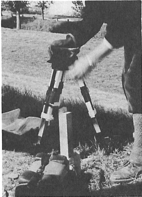
Bild 9: Aufstellen eines kleinen Holzstativs als Ersatz für einen abgebrochenen Pfahl
