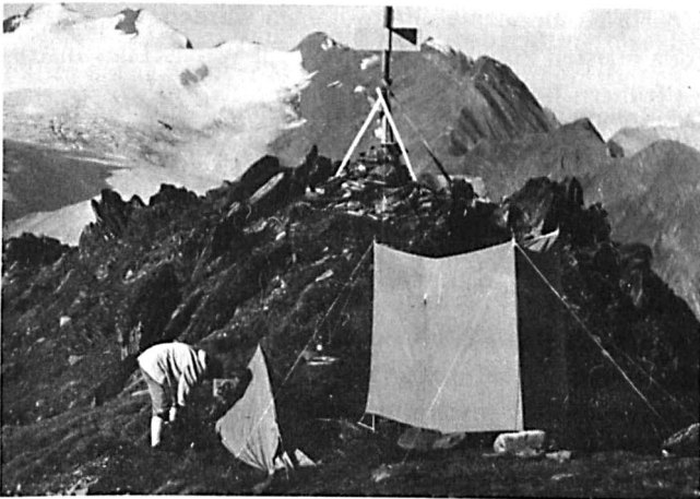
Abb.3 Nufenenstock Astr. Station mit Windschutzwand
