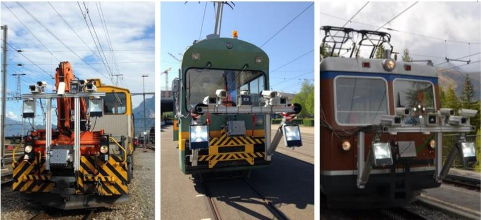
Der Rail Track Scanner aus dem TQual-Projekt im Einsatz bei der Rhätischen Bahn, den Verkehrsbetrieben Zürich und der Gonergratbahn
