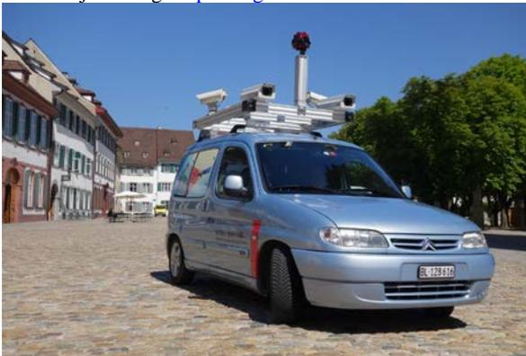
Mobiles Messfahrzeug des IVGI mit einer erweiterten Panorama- und Stereobildsensoren aus dem infraVIS-Projekt auf dem Münsterplatz in Basel
