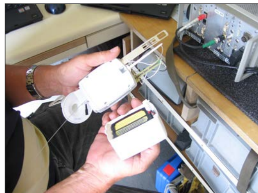
(d) Assembly of all parts belonging to the sonde.
