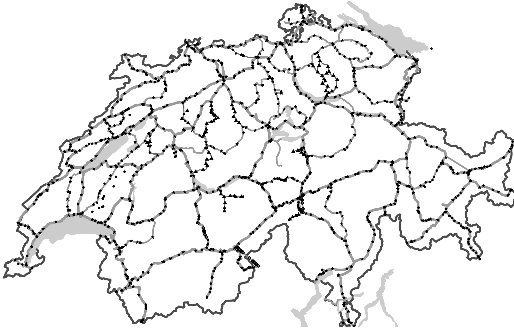
Abbildung 12.2-1: Übersicht über die Transformationsstützpunkte: schmale Linien: kantonale Nivellementmessungen als Bestandteil der kinematischen Ausgleichung und eingezwängte kantonale Nivellementmessungen; Sterne: HFP1 mit Wiederholungsmessungen; Punkte: HFP1 mit einer Messepoche; Dreiecke: HFP2; Kreuze: Tunnelpunkte
