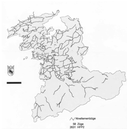
Abbildung 5.3-1: Ehemaliges Netz der kantonalen Nivellementzüge im Kanton Bern (aus [Schlatter et al. 2001]).
