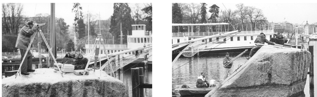
Abbildung 4.5-5: Anschlussmessungen LN 1998 mit Aufnahmen vom grösseren der beiden Pierres du Niton, welcher als Stationspunkt für Nivellement, trigonometrische Höhenübertragung und GPS-Messungen diente. Nahezu aufwändiger als die Messungen war der Transport des Materials per Schlauchboot [Schlatter et al. 2000].
